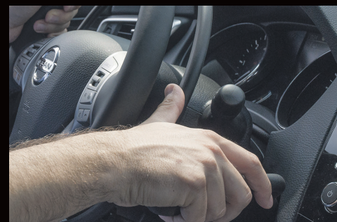
POUCE... QUI Pousse ! De cette façon la main gauche gère le volant, la droite l'accélération et le freinage.
