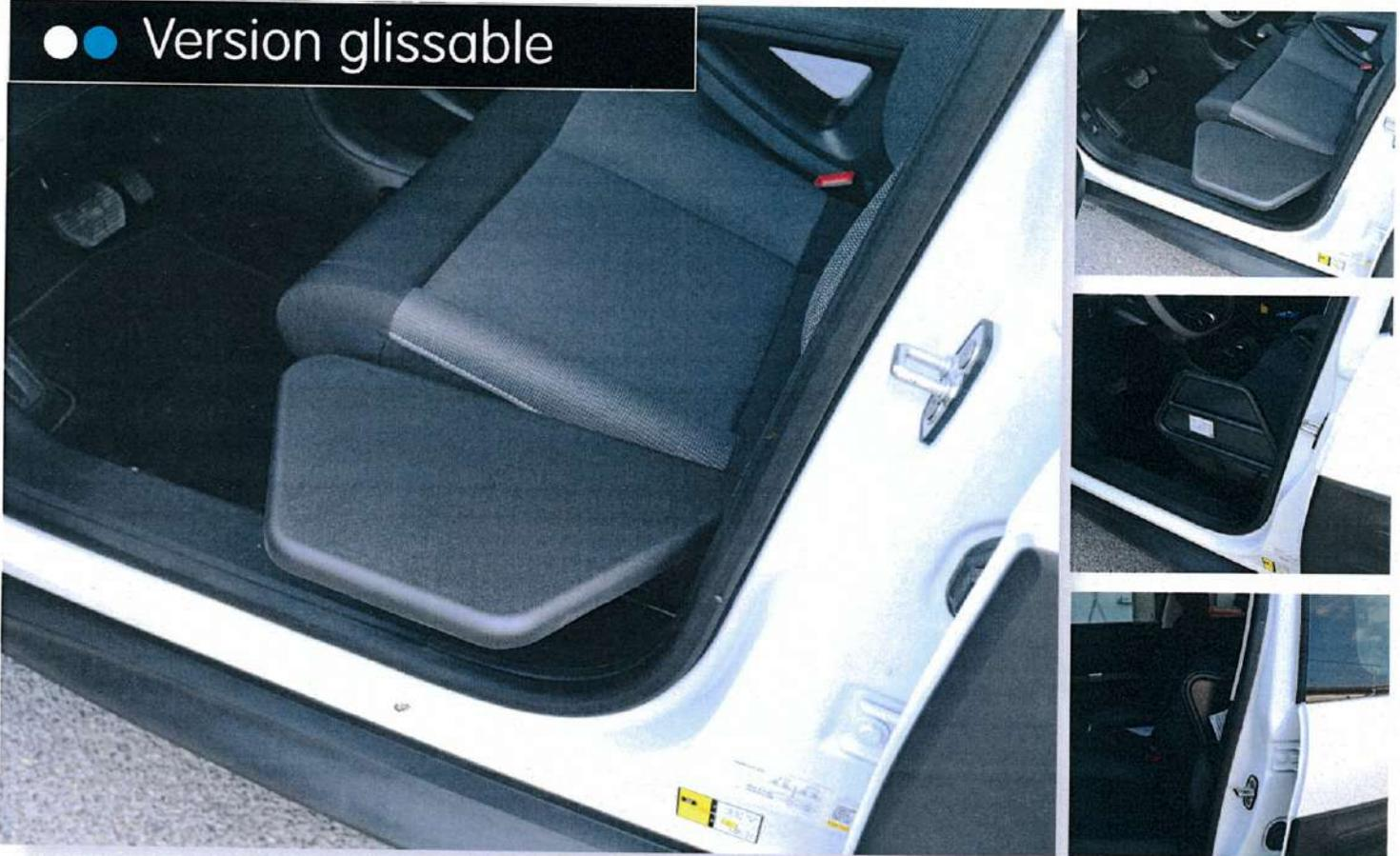
Le plateau de transfert est destiné aux personnes voulant se transférer d'un fauteuil roulant au siège conducteur ou passager d'un véhicule.
